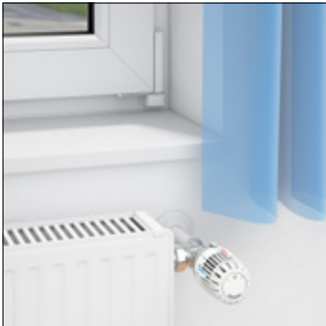
richtig Der Thermostat-Kopf wird ungehindert von der zirkulierenden Raumluft umströmt.
